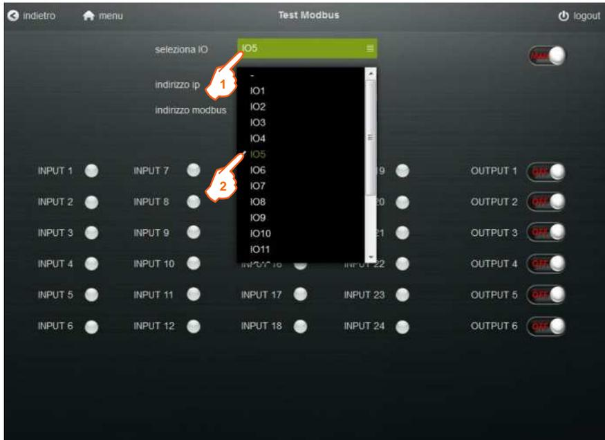
Una volta scelto, dopo qualche secondo, il sistema completerà automaticamente i campi denominati “**indirizzo ip (3)**” e “**indirizzo modbus (4)**”. Al termine di questa procedura si è pronti a procedere col test degli ingressi ed uscite digitali.
