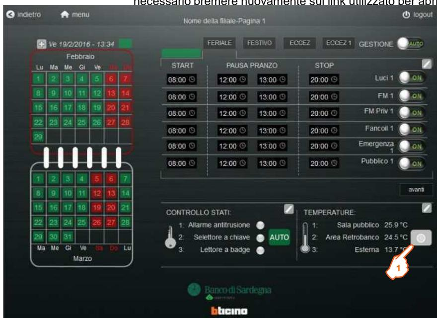
Le logiche sono due: Gestione termica 1 (GT1) - Gestione Termica 2 (GT2). Ognuna delle quali è suddivisa nella programmazione della logica di accensione (ON) e nella programmazione della logica di spegnimento (OFF):
