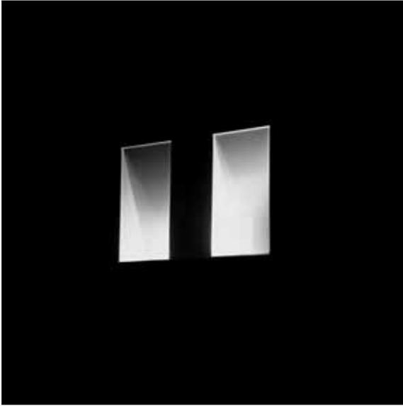
corpo illuminante da incasso per interni IP20 in metallo verniciato bianco o grigio con parabola asimmetrica. mediante le apposite cassaforme, è possibile il montaggio in pareti sia di laterizio che di cartongesso. disponibile in due versioni: corpo 8, a luce indiretta, cablato per lampade alogene, led 3000K 10W o fluorescenti; corpo 14, a doppia emissione, cablato per alogena o fluorescenza (luce indiretta), e con lampada dicroica (luce d'accento) regolabile sull'asse verticale.
