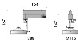
sistema di illuminazione per interni IP20 composto da un faretto orientabile su tre assi, montato su binario 230V o 12V. è disponibile nelle finiture in alluminio ossidato nero o bianco/argento. monta lampade con attacco G53, led AR111, GU5,3/led GU5,3, GX8,5 ed E27 halopar. esiste anche la versione tom a ginocchio in cui è previsto un braccio a L che dà la possibilità di inclinarsi di 180° in modo da ottenere una luce radente lungo le superfici verticali nascondendo il corpo illuminante.
