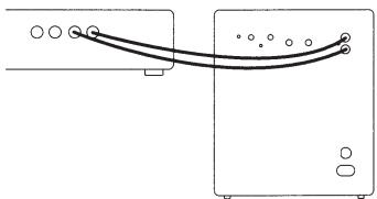
3.2 Si vous utilisez une chaîne hi-fi 2 canaux, raccordez la sortie pré-ampli au connecteur d'entrée de ligne.
