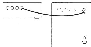
3.1 Si vous utilisez un récepteur AV, raccordez la sortie subwoofer au connecteur d'entrée subwoofer.
